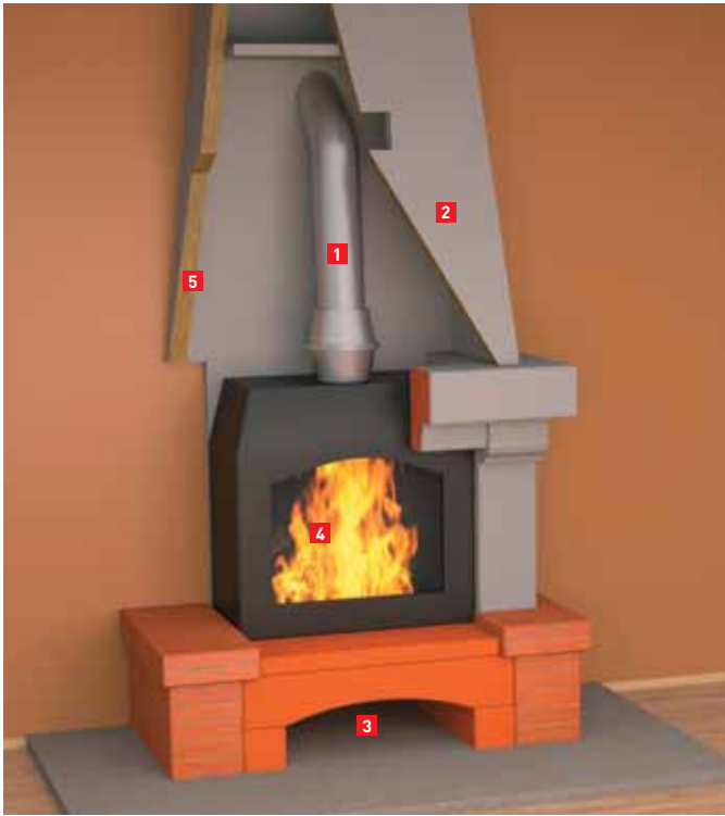
Рисунок 9. Принципиальная схема фальшкамина: 1 – дымоход; 2 – короб; 3 – вентиляционная решетка; 4 – каминная топка; 5 – плиты FIRE BATTS.
