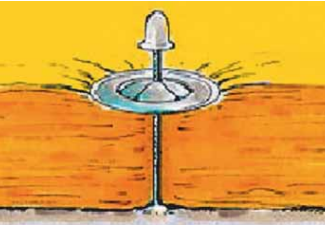
Рисунок 3. Воздуховод с огнезащитным покрытием WIRED MAT 80 в разрезе: 1 – воздуховод; 2 – приварной штифт с шайбой; 3 – покрытие алюминиевой фольгой; 4 – WIRED MAT 80.
